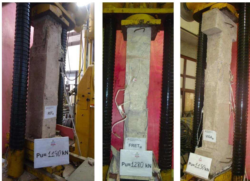
Figura 4.26 – Pilares monolíticos após a ruptura
