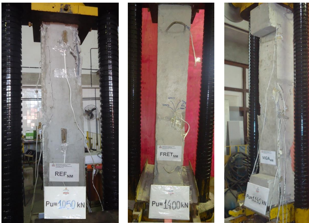
Figura 4.27 – Pilares não monolíticos após a ruptura
